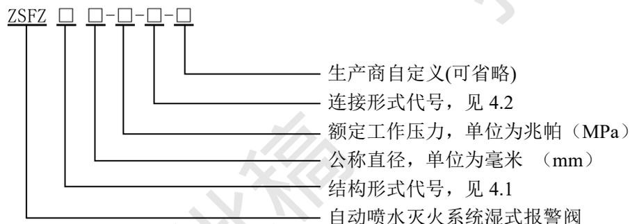
示例：ZSFZ D 100-1.2-G 表示连接形式为沟槽连接，额定工作压力为 1.2 MPa，公称直径为 100 mm 的蝶阀型湿式报警阀。
