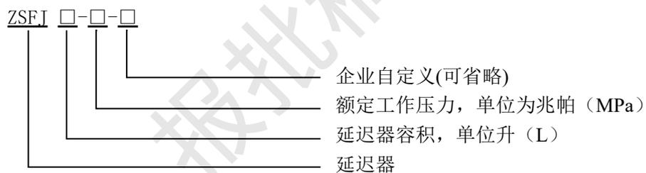
示例：ZSFJ 1.8-1.2表示额定工作压力1.2 MPa、容积为1.8 L的延迟器。
