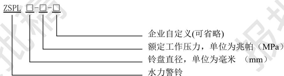
示例：ZSPL 150-1.2表示额定工作压力1.2 MPa、铃盘直径为150 mm的水力警铃。
